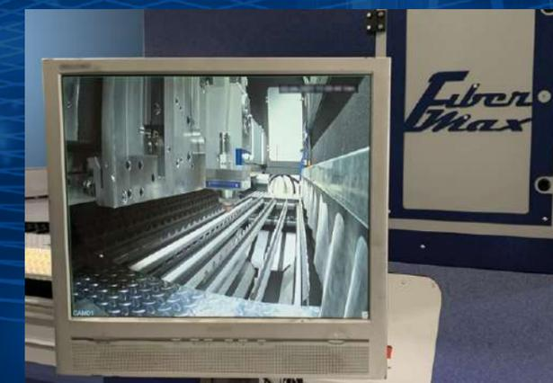
Al fine di osservare le lavorazioni eseguite in piena sicurezza per l'operatore, l'interno dell'involucro è illuminato e dotato di un' apposita videocamera di sorveglianza collegata ad un monitor esterno dal quale è possibile controllare il corretto funzionamento della macchina taglio laser.
